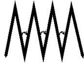
Fig. 16: Längenmessen durch Abschlagen
