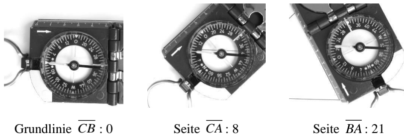
Abbildung 6: Zeichnen des Bilddreiecks mit dem Kompass
